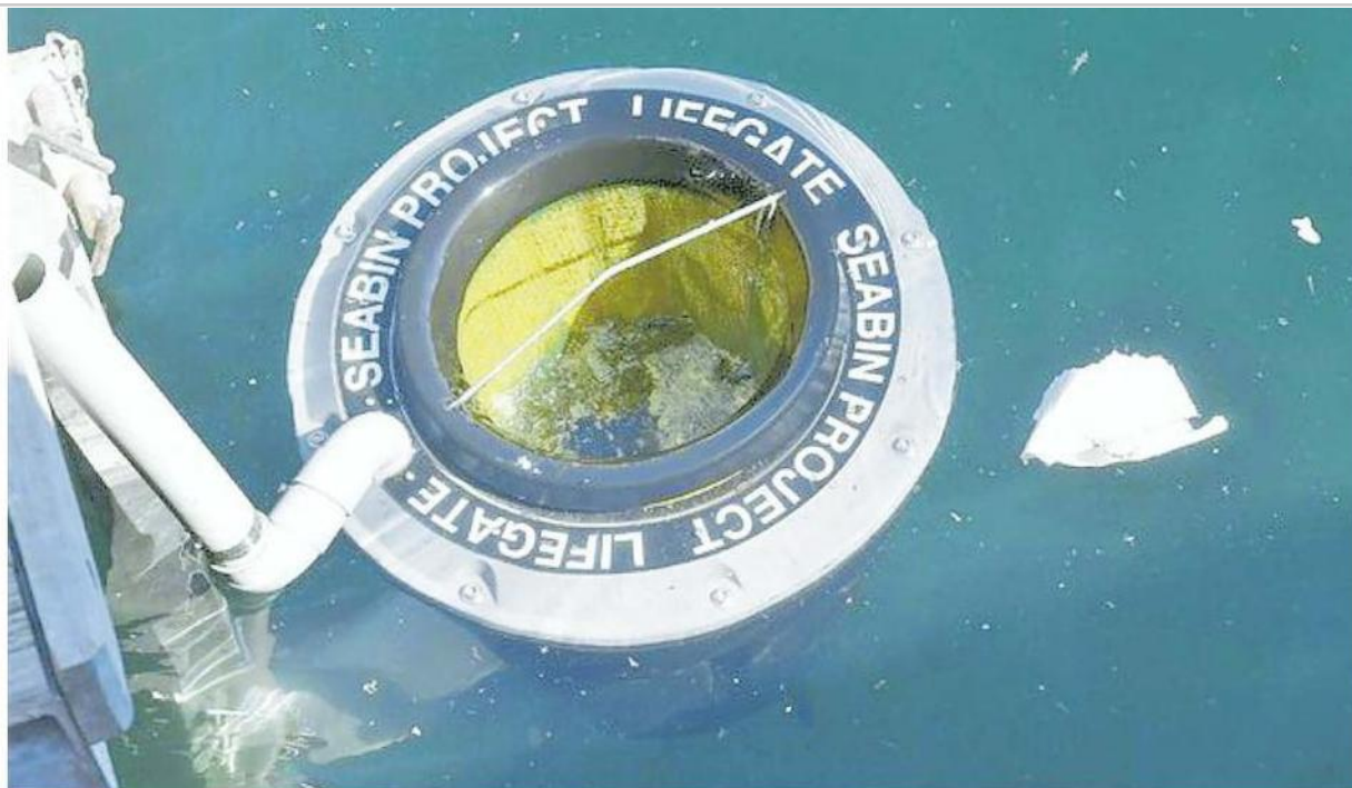
▲ Seabin Sono i cestini che vengono messi nei porticcioli per aspirare la plastica
